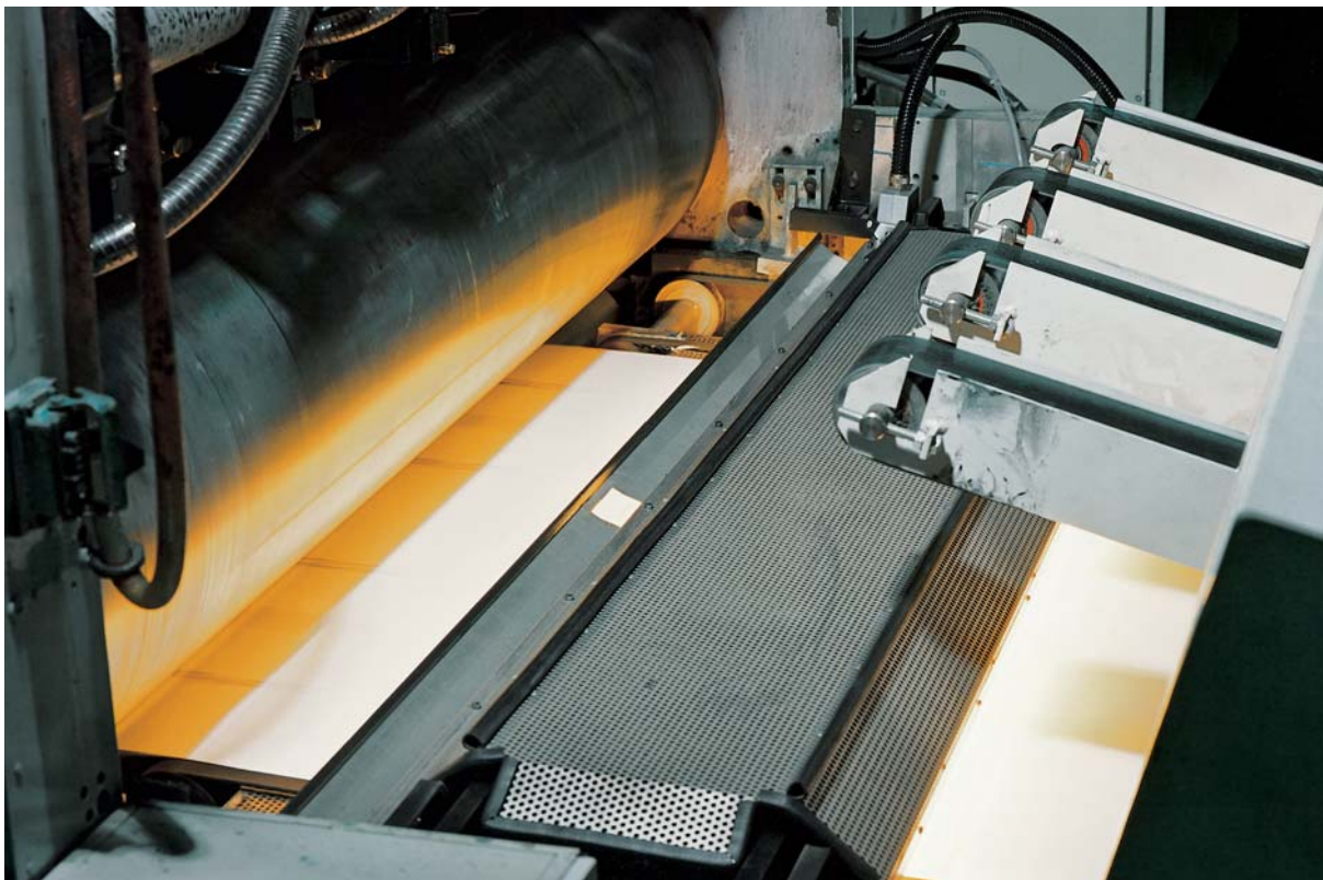
Papier Trocknung mit IR-Strahlung Quelle: Jac de Vries, NL
